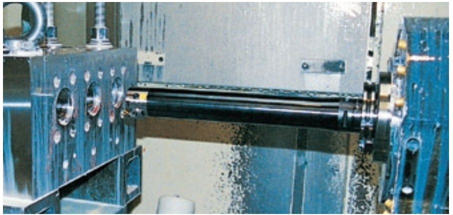
Применение антивибрационной оправки при большом вылете инструмента.
