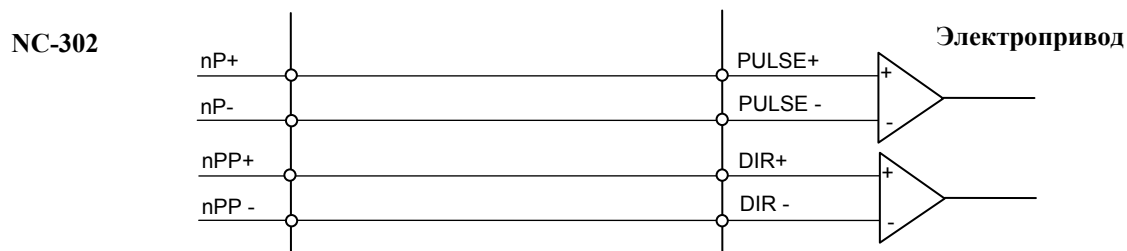
Рисунок 4.14 – Подключение к приводу дифференциальных сигналов ЦИП
